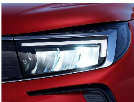
Intelli-Lux LED® pixelové svetlo Adaptívne svetlá s 84 LED prvkami v každom svetle s automatickým vypínaním jednotlivých jednotiek
