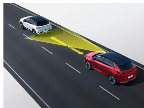
Adaptívny tempomat automaticky udržiava nastavenú rýchlosť a vzdialenosť od vozidla vpredu brzdením alebo zrýchľovaním
